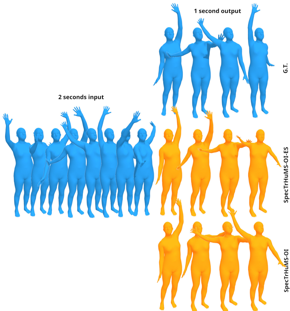
FIGURE 5.4 – Comparaison visuelle de notre modèle utilisant une identité dont l’entraînement a été arrêté prématurément (SpecTrHuMS-OI-ES) avec notre modèle entièrement entraîné (SpecTrHuMS-OI) sur la base de données de test. Alors que le modèle arrêté prématurément donne de meilleurs scores MPJPE, le modèle entièrement entraîné est capable de mieux préserver les longueurs des arêtes. Les maillages bleus représentent les vérités terrain avec une MELV de 0,72 mm. Les maillages oranges représentent la génération de nos modèles, avec une MELV de 2,03 mm pour le SpecTrHuMS-OI-ES et de 0,59 mm pour le SpecTrHuMS-OI. Toutes les MELV indiquées dans cette légende concernent le dernier pas de temps.
