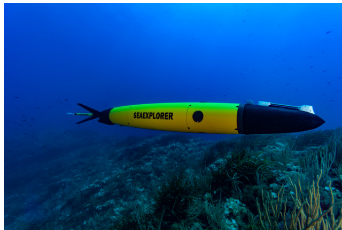
Figure 1.15 – Planeur SeaExplorer d’Alseamar
