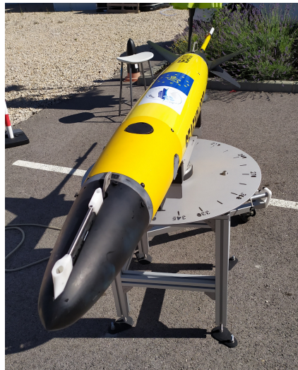
Figure 4.12 – Table de calibration compas en extérieur
