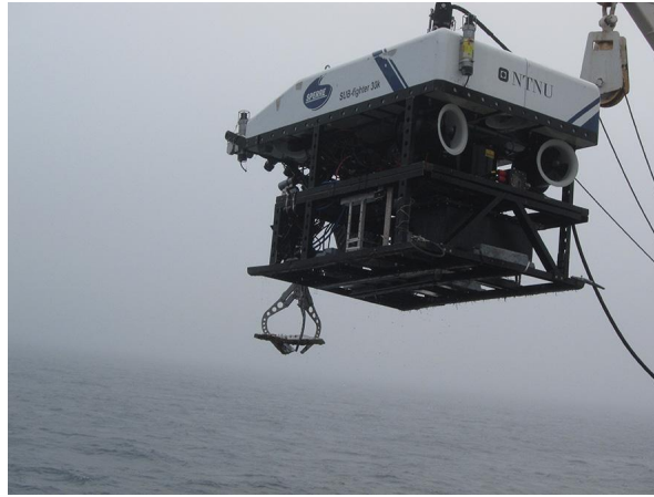
Figure 1.3 – ROV 30K de l'AURLab permettant d'aller jusqu'à 6000m de profondeur
