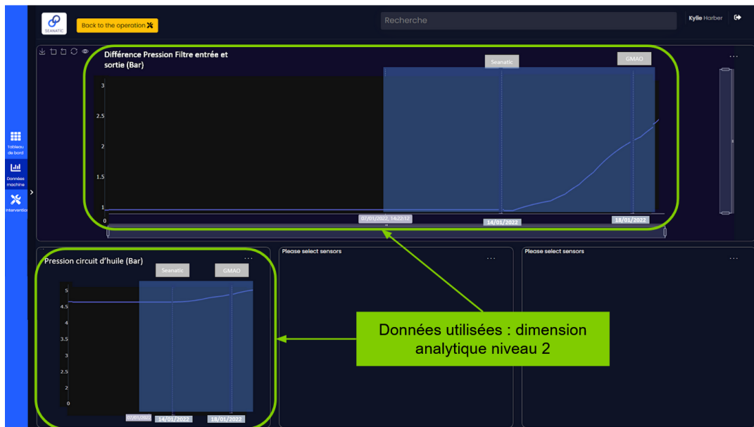
Figure 7.2 : Représentation des données lorsque la proposition est d’avancer un changement de filtre
