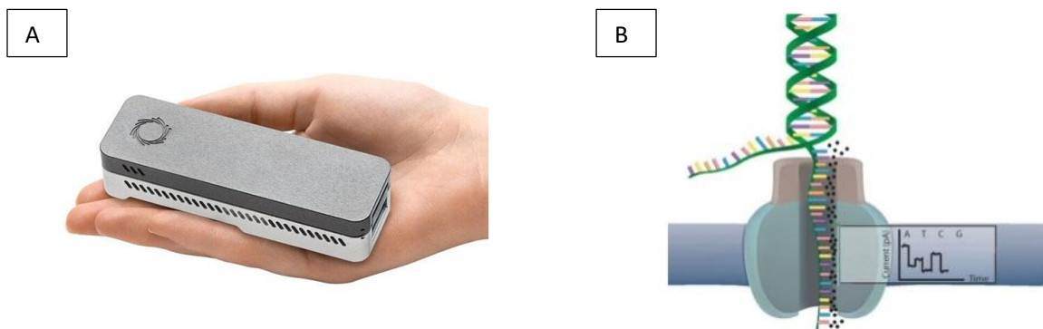
Figure 5 : Technologie Oxford Nanopore Technology (ONT). (A) Séquenceur Minion. (B) Pore protéique laissant passer la molécule d'ADN. Le signal de différence de potentiel mesuré correspond au passage de 5 bases dans le pore
