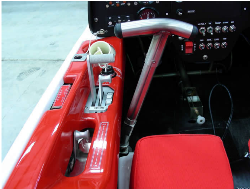
Photographie V-33 : Malonnier équipant un ULM SkyArrow
