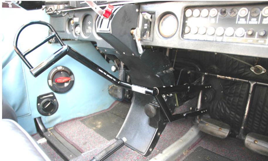
Photographie V-32 : Piper PA28 adapté avec le malonnier Blackwood
