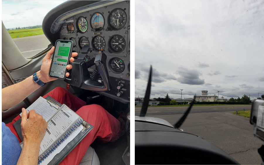
Photographie VI-57 : Demande d'autorisation de roulage par écrit numérique du pilote sourd (à gauche), réponse lumineuse négative rouge « arrêtez-vous » par lightgun du contrôleur d'aérodrome (à droite)
