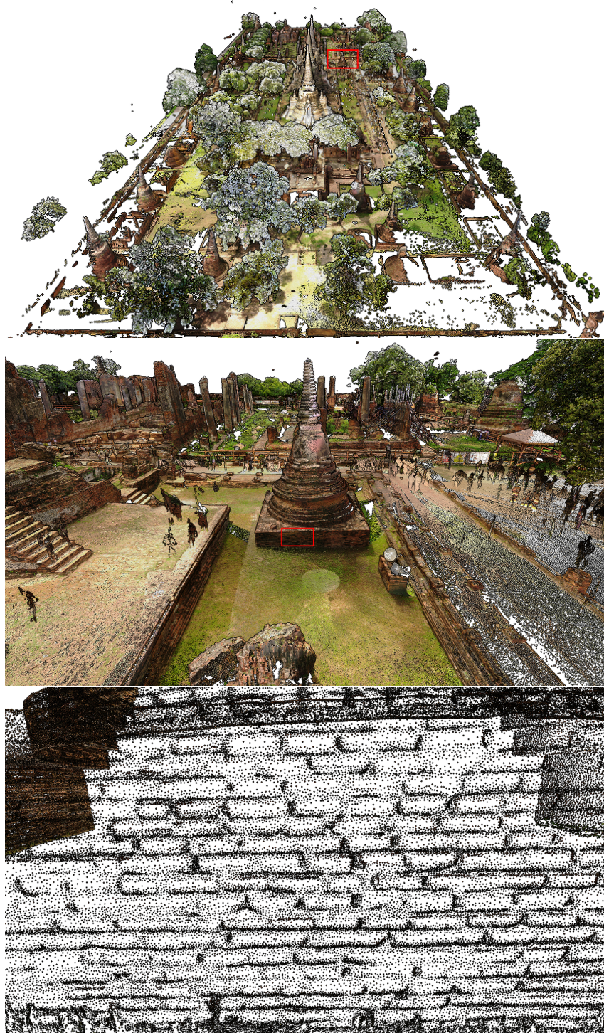
FIGURE 48 – WAT PHRA SI SANPHET (40 km 2 , 5,3 milliards de points, 156 acquisitions) [Goo] ré-échantillonné de manière adaptative avec 155 millions de points (2,8%).
