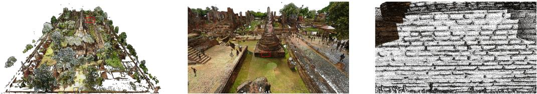
FIGURE 8 – Ré-échantillonnage (155 millions de points) d'un site de 40 000m<sup>2</sup> [BPA20]. Données initiales : 5,3 milliards de points.
