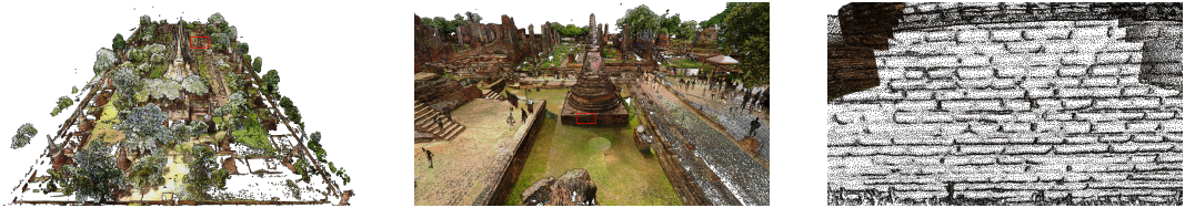
FIGURE 8 – Ré-échantillonnage (155 millions de points) d'un site de 40 000m 2 [BPA20]. Données initiales : 5,3 milliards de points.
