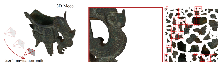
FIGURE 13 – Ce que l’on voit d’un point de vue donné (au centre), et les blocs de texture correspondant dans l’atlas (droite) [MB+19].
