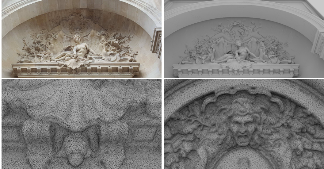
FIGURE 51 – Façade du PALAIS DE LA DÉCOUVERTE [Agp], et surface correspondante reconstruite avec [BL17] à partir d’une DDP adaptative.
