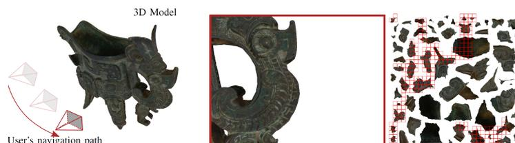
FIGURE 13 – Ce que l’on voit d’un point de vue donné (au centre), et les blocs de texture correspondant dans l’atlas (droite) [MB+19].
