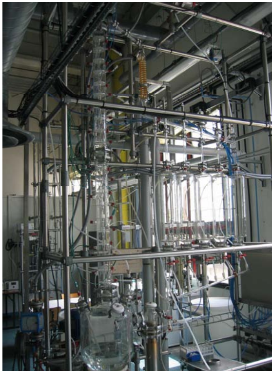
colonne à distiller discontinue à l'AIGEP
