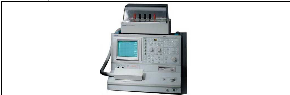
Figure 1 - Image du traceur Tektronix 371A associé à son boîtier de connexion.
