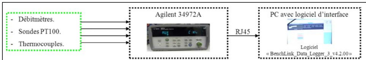
Figure 19 - Schéma de principe de la chaîne d'acquisition des mesures de températures et de débits.
