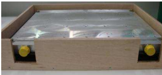
(a) plaque de refroidissement dans sa boîte isolante en bois et mousse isolante en fond.
