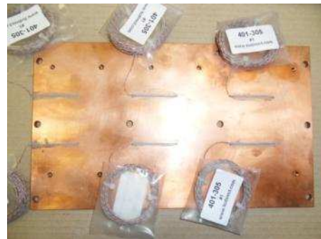
(b) semelle d'interface équipée de thermocouples placés dans les rainures.
