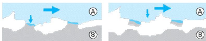
Figure 12 - Phénomènes élémentaires de l'usure adhésive : formation de transfert
