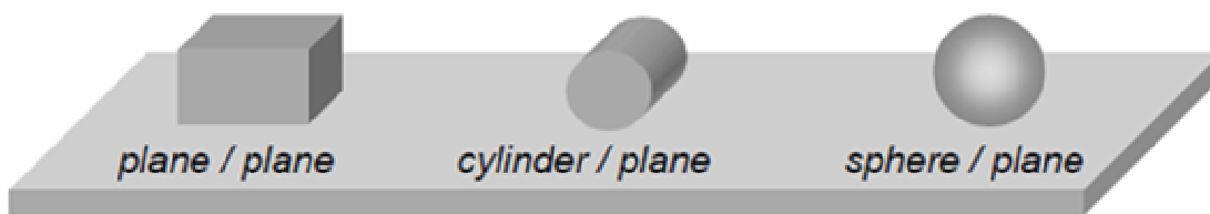
Figure 13 : Configurations de géométrie de contacts simplifiées en fretting
