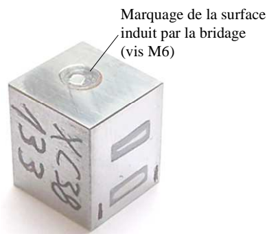
Figure 45 : Observation de l'échantillon fretting wear après serrage (marquage de la surface induit par le bridage (vis M6))
