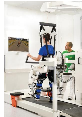
Figure 9 : Lokomat pour la marche
