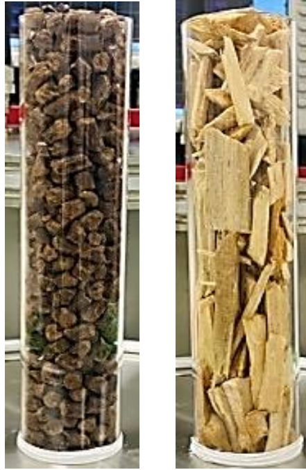
Figure 76 : photo de l'échantillon rempli dans le tube en verre. (gauche) granulés de bois. (droite) plaquettes de bois.
