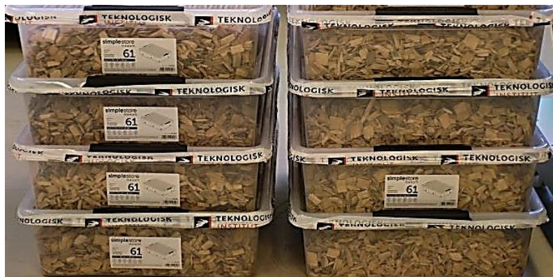
Figure 114 : échantillons des plaquettes de bois avec différents taux d'humidité.
