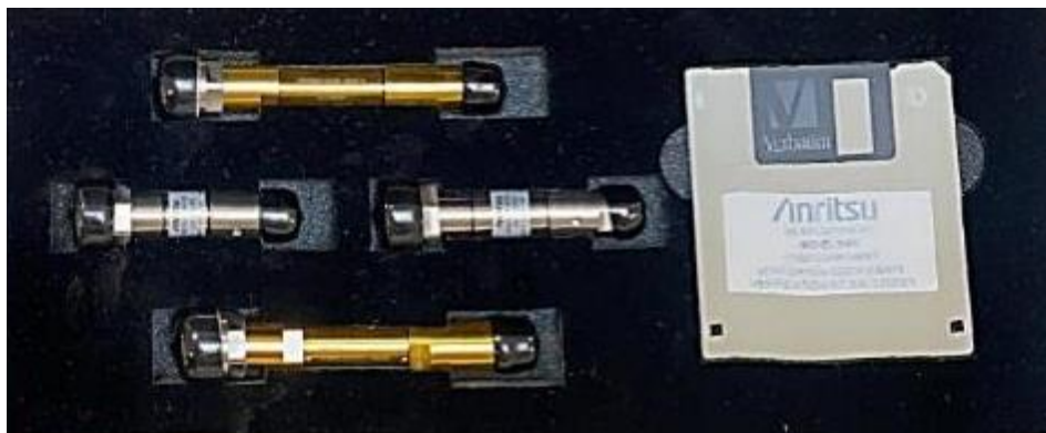
Figure 22 : le kit de vérification fourni par Anritsu - Modèle 3663A.
