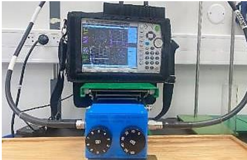
Figure 30 : photo de l'atténuateur variable manuel GKTS2-2-69-18-A7-B-N (M,F) , fourni par Anritsu , connecté au VNA.
