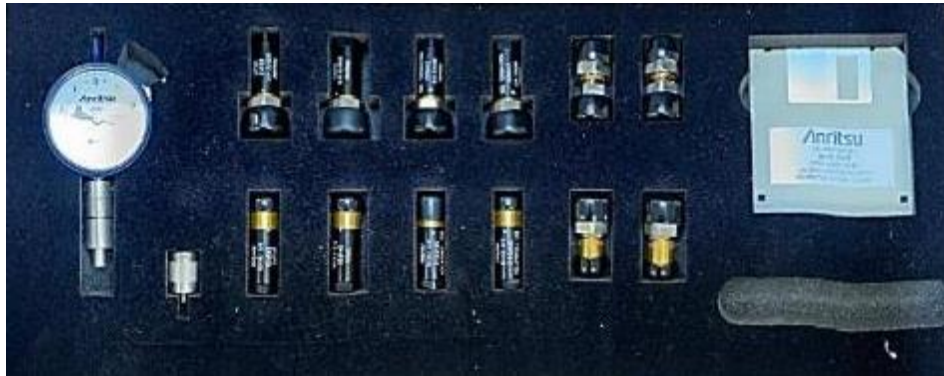
Figure 21 : le kit d'étalonnage utilisé pour étalonner le VNA, fourni par Anritsu - Modèle 3653A.
