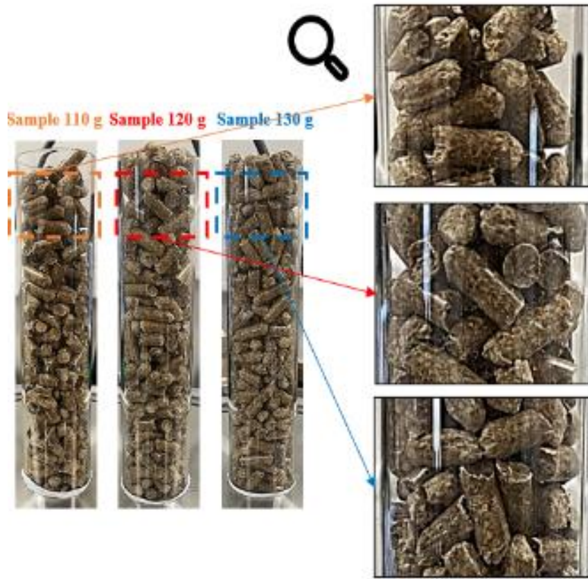
Figure 82 : photos de remplissage de tube en verre avec trois masses différentes.
