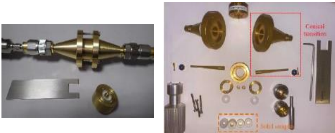
Figure 47 : photos de la cellule coaxiale EpsiMu ® .
