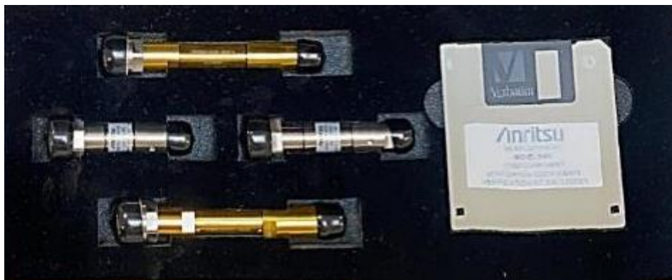
Figure 22 : le kit de vérification fourni par Anritsu - Modèle 3663A.
