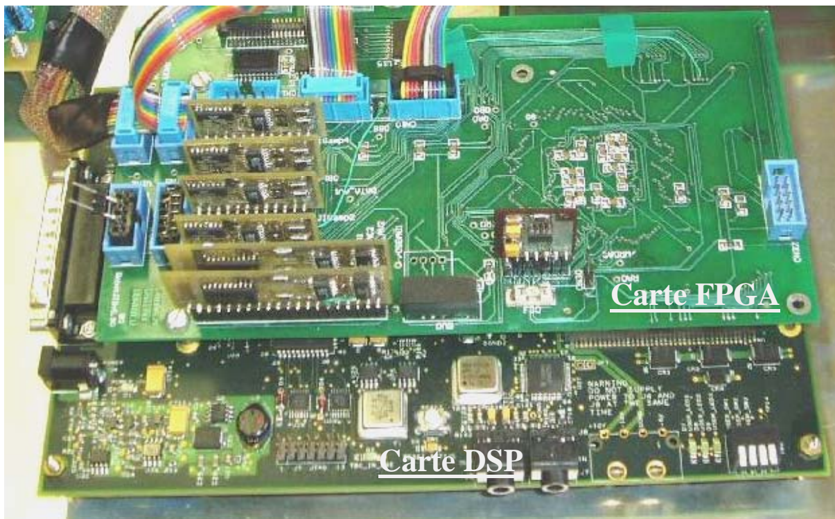
Figure C-3 : Photo de la carte DSP et de la carte FPGA
