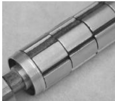
Figure II-35 : Rotor à aimants décalés par blocs
