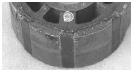
Figure II-34 : Rotor comportant différentes largeurs d'aimant
