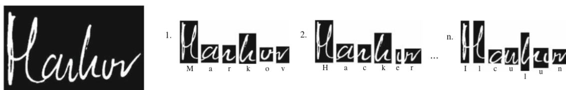
Figure 2.3 – Ambiguïtés liées à la segmentation en caractères : différentes façons de segmenter le mot ont un impact sur la reconnaissance (figure issue de [Plötz 2009])
