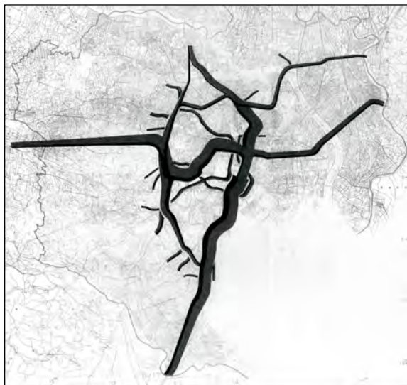
Figure 30 (a) (gauche) : Extrait de la planche n° 7.1 « Kokutetsu - chikatetsu yusôryô / Volume of passengers - national railways and underground railways » à Tôkyô en 1955
