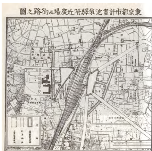
Figure 95 (gauche) : Le plan d'aménagement des places et des voies au voisinage de la gare d'Ikebukuro à Tôkyô ( Tôkyô toshikeikaku Ikebukuro eki fukin hiroba kyûgairo zu ) de 1936 élaboré par la Commission régionale d'urbanisme (échelle graphique du plan : de 0 à 300 mètres)
