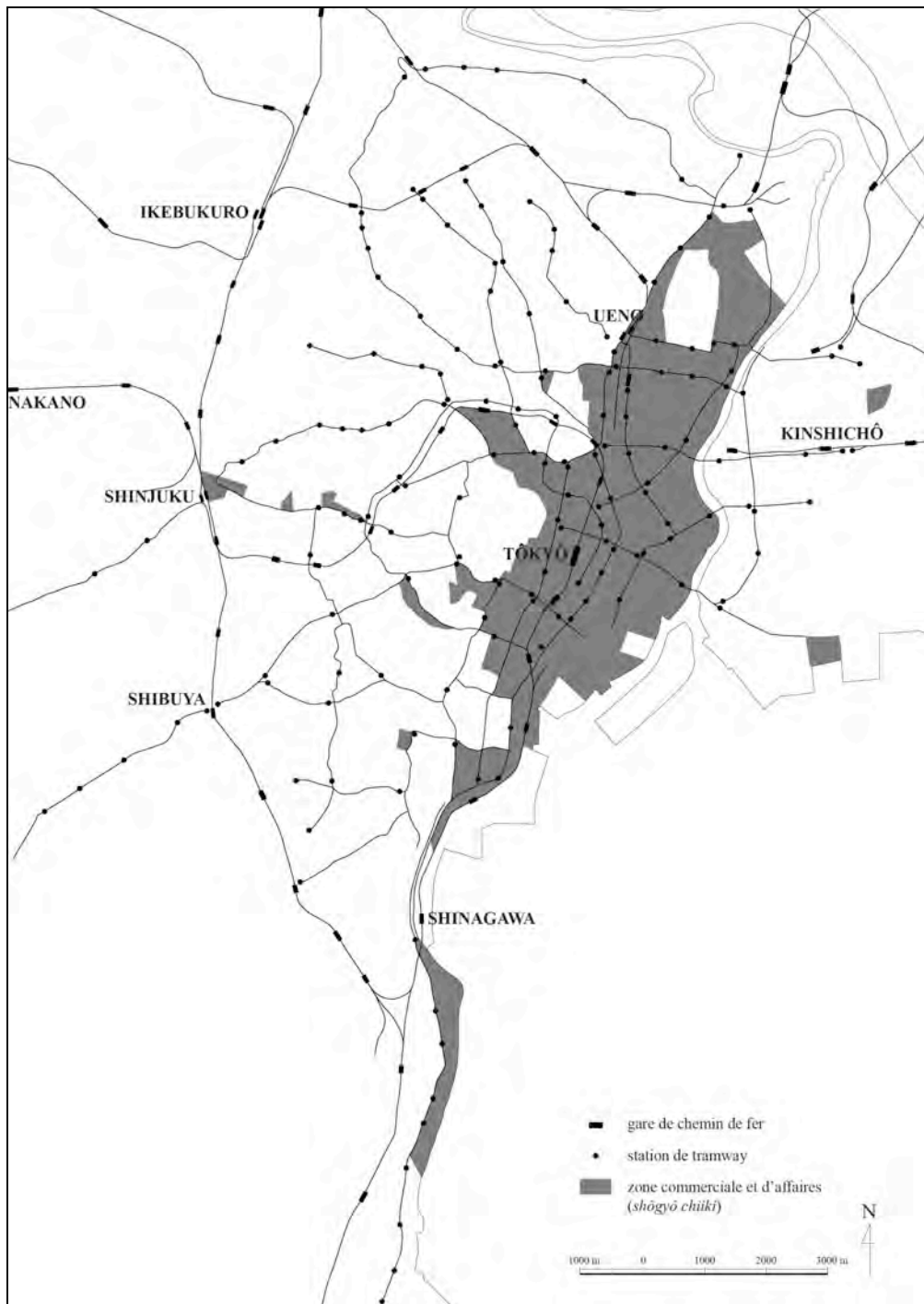
Figure 35 (a) : Schéma des relations entre la zone commerciale et d'affaires désignée en 1925 et l'emprise du réseau de transport ferré à Tôkyô (état du réseau en 1921)
