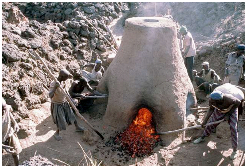
Fig. 51 : Réactivation de la réduction du minerai de fer à Aridyini (Photographie de la MAESAO).
