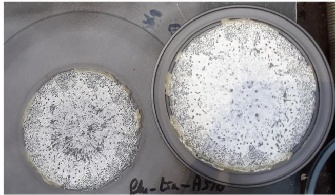
FIGURE 2.19 – Exemple d'un faciès de rupture pour un essai de fluage en traction à 50°C
