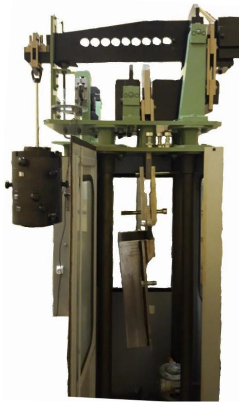
FIGURE 2.13 – Machine de relaxation adaptée à un essai de fluage
