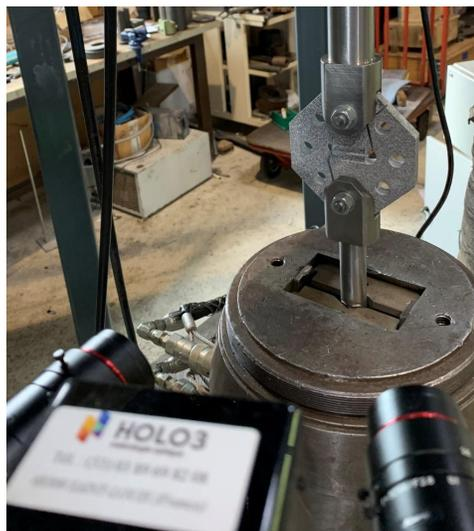
FIGURE 3.12 – Essai quasi statique avec mesure des déplacements par corrélation d'images
