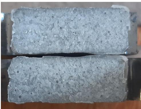
FIGURE 3.19 – Exemple d'un faciès de rupture pour un protocole de collage validé
