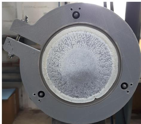
FIGURE 2.9 – Faciès de rupture pour un essai monotone de cisaillement
