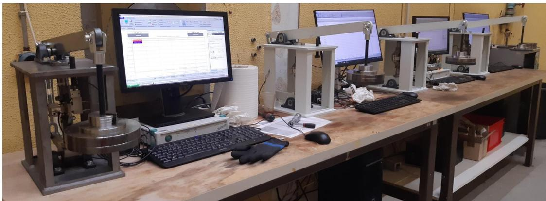
FIGURE 3.1 – Ensemble des quatre bâtis de fluage utilisés
