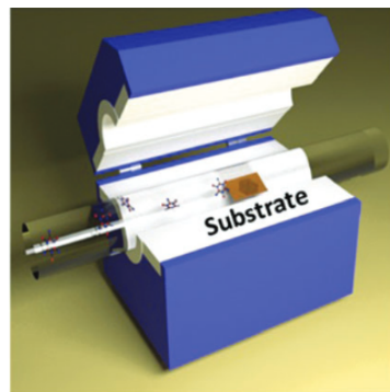
FIGURE I.7 – Schéma de principe d'un réacteur de CVD thermique [27].
