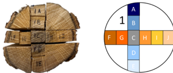
FIGURE 5.20 – Mesure de retrait longitudinal. Échantillonnage des sections, selon deux axes : vertical (bleu) et horizontal (orange), centrés sur la moelle.
