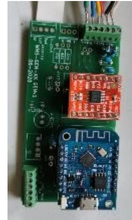
FIGURE D.6 – Module électronique d'acquisition et de transmission des données associé aux capteurs.
