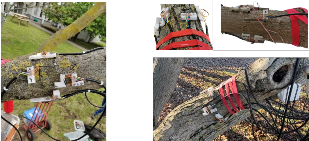
FIGURE D.5 – Représentation des capteurs positionnés sur la branche étudiée. Les capteurs sont disposés circonférentiellement sur deux sections de la branche.
