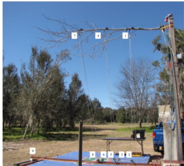
FIGURE 1.14 – Dispositif de mise en flexion de branches de Miesbauer et al. (2014). A l'aide d'un système de poulies au sol et de différents points d'ancrage, le système permet d'appliquer une charge en flexion de manière « continue » et homogène sur la branche.
