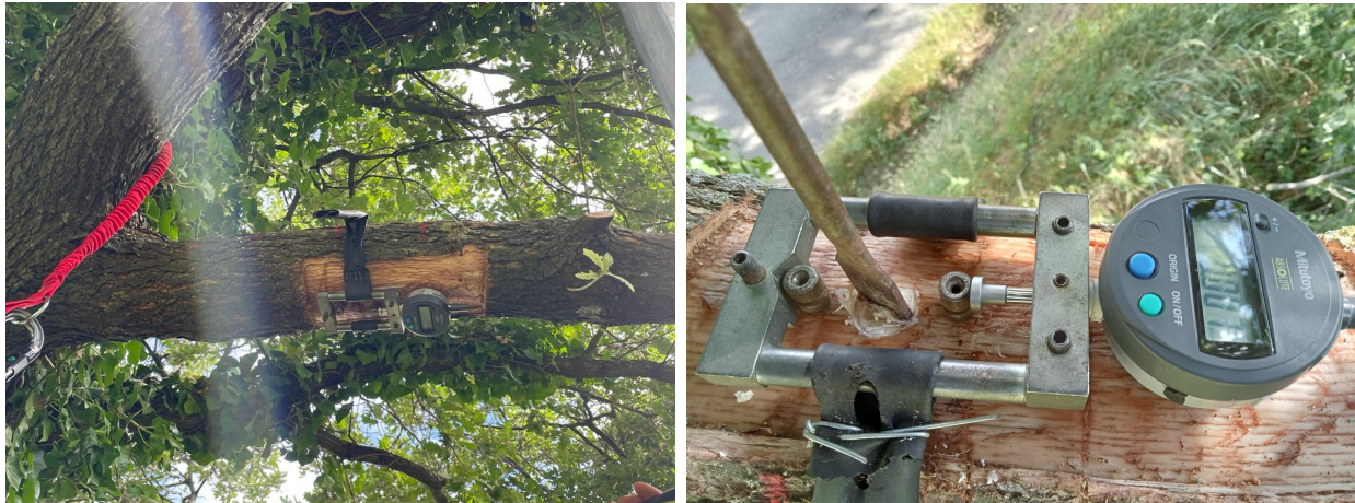
FIGURE 5.25 – Mesure des déformations de maturation à l’aide de la méthode du trou unique.
