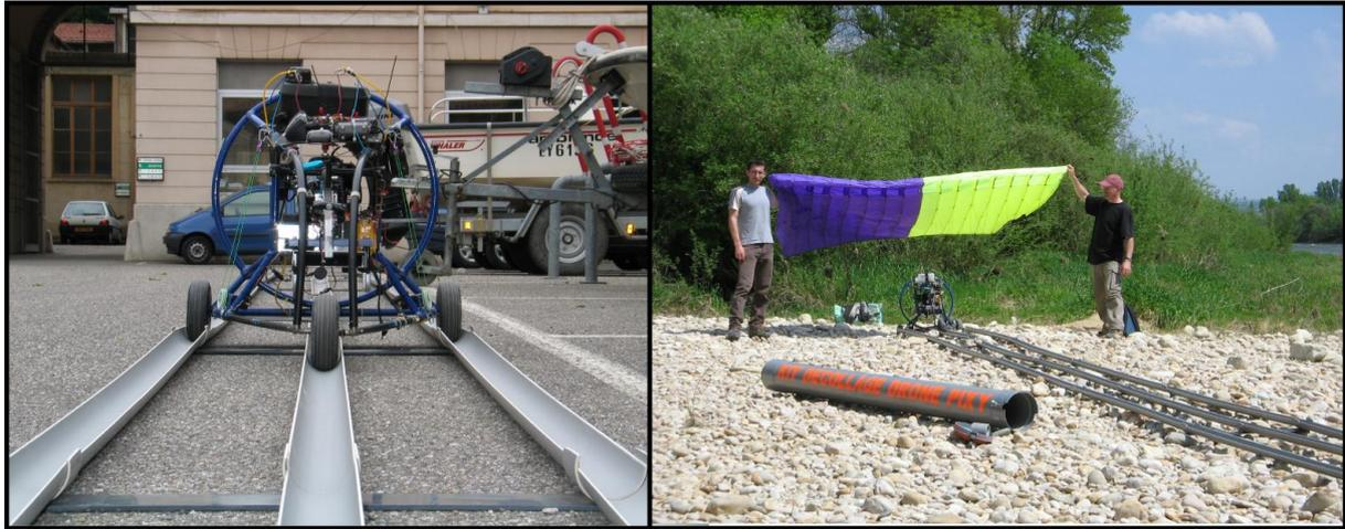
Figure 3-2. Rampe de lancement drone « tri-tube » et son installation *in situ*
