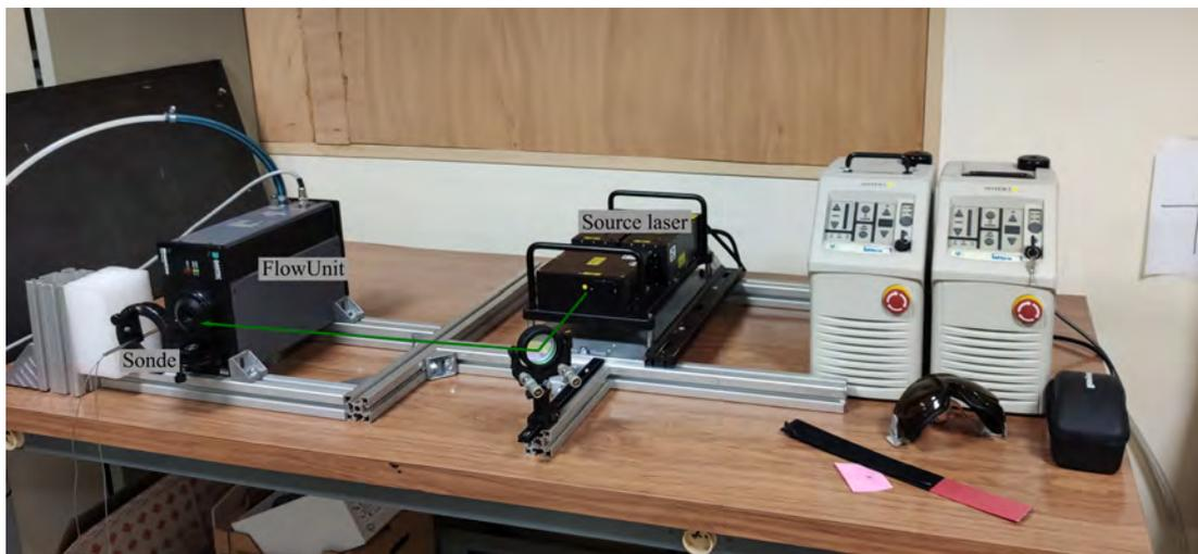
FIGURE 8.1. – Montage expérimental utilisé pour déterminer la réponse fréquentielle des micro-capteurs en mode fil froid.
