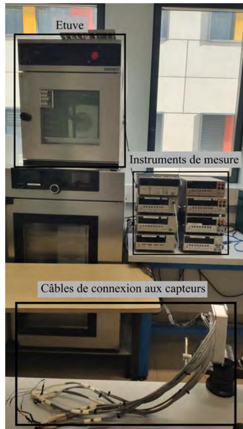
FIGURE 6.4. – Outils de caractérisation des paramètres thermo-électriques  $R_0$  et  $\chi$ .
