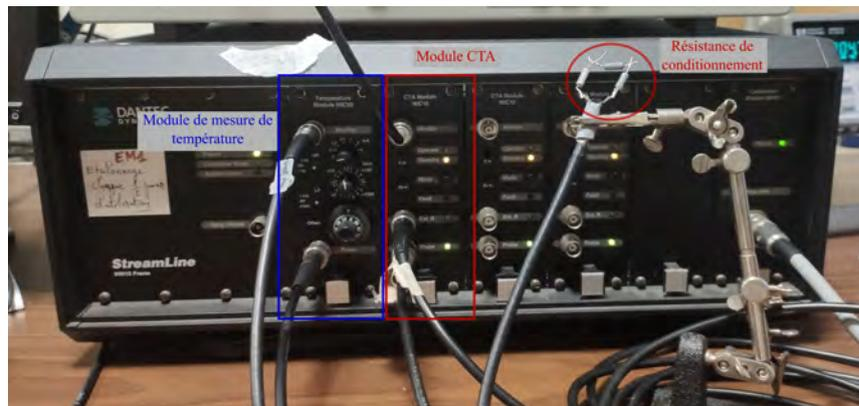
FIGURE 6.8. – Modules électroniques utilisés pour les mesures de vitesse et de température.
