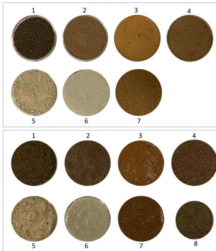
Figure II.4. Photographies des échantillons de sols secs (en haut) et à saturation (en bas) du jeu de données Dup20. L'échantillon 8 n'a pas été photographié à l'état sec. Ces images ne sont pas calibrées en luminance, elles servent uniquement d'illustration mais ne peuvent pas être utilisées pour faire des comparaisons de luminance ou colorimétriques.
