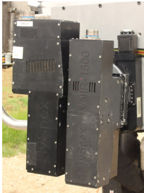
Figure IV.17. Caméras VNIR et SWIR utilisées pour l'acquisition des images lors de la campagne organisée dans le cadre de la thèse d'Etienne Ducasse.
