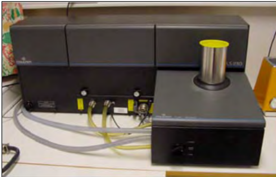
Figure 4.19 – Granulomètre à diffractométrie laser Coulter LS-200, semblable à celui utilisé à Géoscience Azur lors de cette étude.
