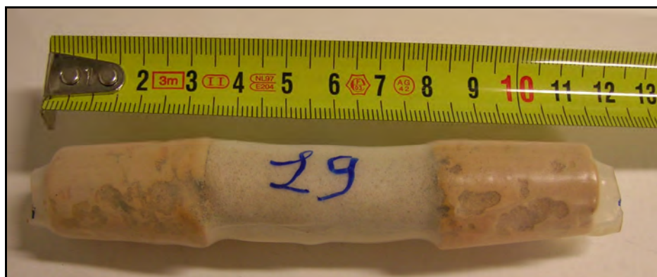
Figure 5.3 – Echantillon de sable contenant une structure de type BDCs à brins multiples (référéncé C19) contenu dans un film thermorétractable, obtenu par méthode des tubes en cuivre. Les deux extrémités de l’échantillon cylindrique sont scellées par des bouchons en liège.
