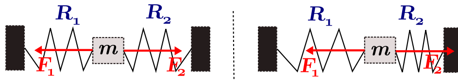
FIGURE 2.1: Illustration de l'idée fondamentale de la théorie du point d'équilibre. A gauche, les deux ressorts sont à l'équilibre (les raideurs sont identiques, et donc la masse est au centre). A droite, la raideur d'un des deux ressort a été changée subitement, cela a produit un mouvement vers une nouvelle position d'équilibre.
