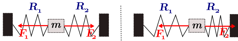
FIGURE 2.1: Illustration de l'idée fondamentale de la théorie du point d'équilibre. À gauche, les deux ressorts sont à l'équilibre (les raideurs sont identiques, et donc la masse est au centre). À droite, la raideur d'un des deux ressort a été changée subitement, cela a produit un mouvement vers une nouvelle position d'équilibre.
