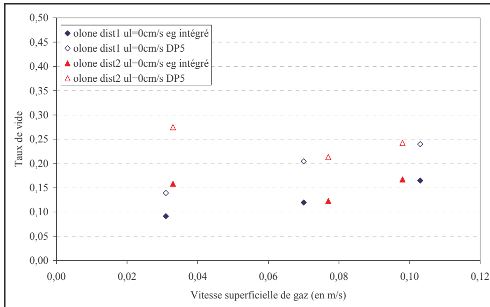
Figure 57 : Comparaison des taux de vide globaux et locaux intégrés sur une section de colonne
