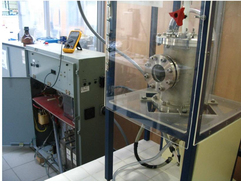
*Figure III.6 : Montage expérimental du système de décharges d'arc électrique pulsées utilisé dans nos travaux*
