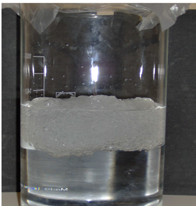
Figure 51 : Précipitation de HA hydrolysé par réaction enzymatique. Conditions de précipitation : éthanol/eau (80/20) (v/v) avec [\text{NaCl}] = 0,15 \text{ mol.L}^{-1} dans la phase aqueuse.
