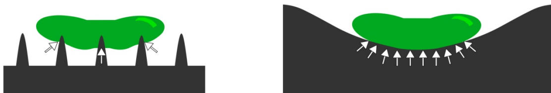
Figure 1. 5 Illustration de la théorie des points d'accroche. Les microorganismes ont peu de points d'accroche (flèches blanches) sur des surfaces structurées dont les reliefs sont plus petits qu'eux.
