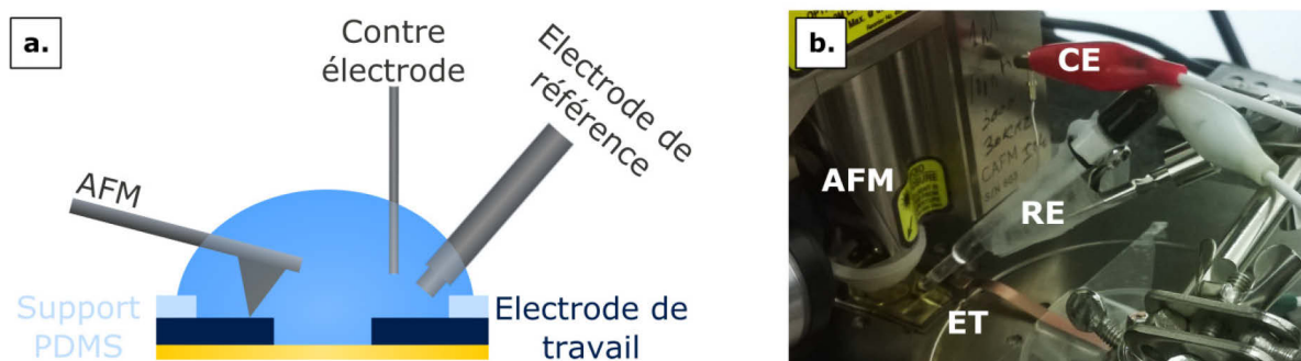
Figure 2. 13 Expérience d'AFM liquide sous activation permettant de mesurer l'évolution de la topographie et de l'épaisseur du film polymère en fonction de la tension électrique : schéma de fonctionnement (a), photo du dispositif (b) ET représente l'électrode de travail, RE la référence et CE la contre.
