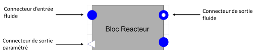
Figure 1 : Exemple de composant avec des connecteurs
