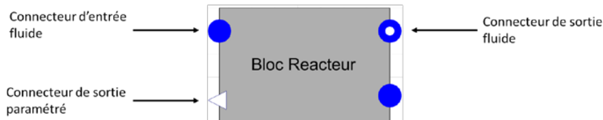
Figure 1 : Exemple de composant avec des connecteurs
