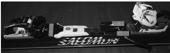
Fig. 13. Les zones de contact entre chaussure et fixation de ski alpin (zones hachurées et rouges), sur la fixation.
