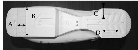
Fig. 12. Les zones de contact entre chaussure et fixation de ski alpin (zones hachurées et rouges), sous la chaussure. Les dimensions sont les suivantes : a : 20mm ; B : 69(±2) mm (voir Fig.5) ; C : 12 mm ; D : 40 mm.
