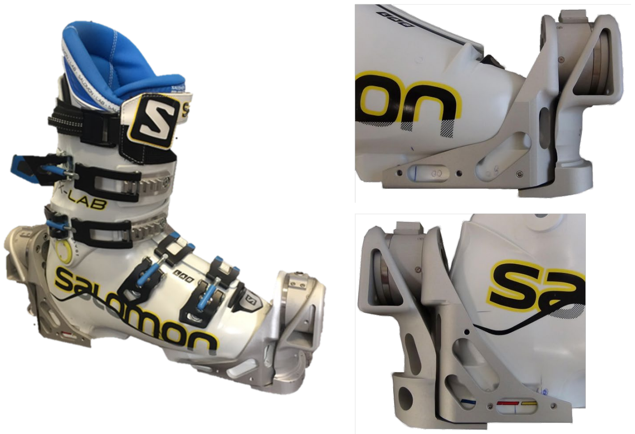
Figure 17 : Photos représentant la vue globale, avant et arrière du capteur de force 3D développé au cours de la thèse de T. Falda.
