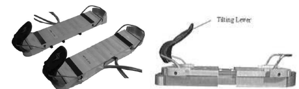
Fig. 17a et b. Une plateforme de force à insérer en tant qu'interface entre les chaussures et les fixations (solution B). a) D'après Meyer et al. 2011; b) d'après Kieffmann et al. 2006.
