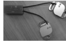
Fig.14. Un microdatalogger s'occupant de l'alimentation et du stockage des données, ici de deux capteurs de force uni-axiaux. D'après Freeseense.
