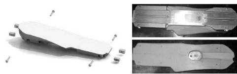
Fig. 19. Une semelle intercalaire instrumentée (solution D). Elle permet de mesurer les moments My et Mx (d'après Petrone et al. 2010).
