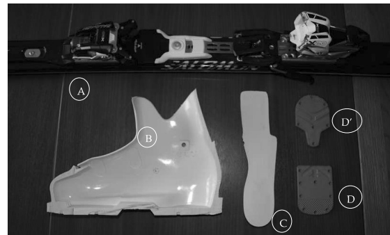
Fig. 2. L'ensemble des pièces qui composent l'interface ski/fixation/chaussure : le ski + la fixation de ski (A), la coque de la chaussure (B), la semelle intercalaire (C), les cales de surélévation avant (D) et arrière (D').
