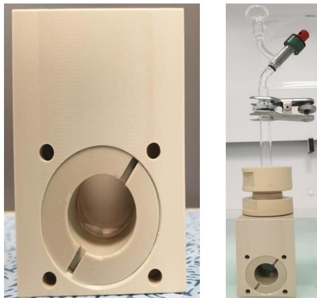
Figure 23: [gauche] photo de la cellule avec vue sur la fenêtre en verre borosilicaté de 150 \mu\text{m} d'épaisseur et 25 mm de diamètre. [droite] Photo de la cellule pour les irradiations \alpha avec le système de rétention des gaz.
