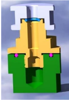
Figure 19: [gauche], plan en coupe de la cellule d’irradiation en PEEK développée pour des faibles volumes ( V=5 ml) au sein du laboratoire Subatech. [droite], photo de la cellule avec le système de rétention des gaz.
