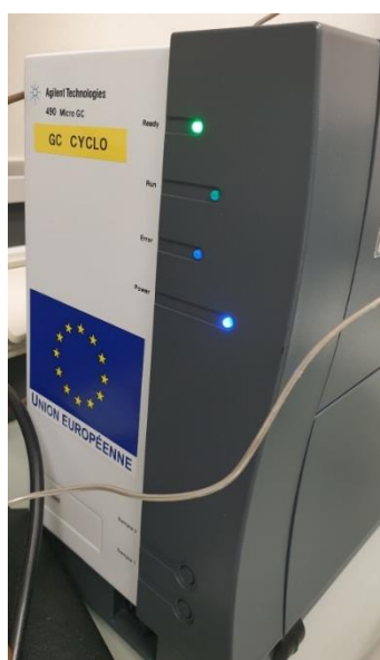
Figure 30 : \mu -chromatographie gaz modèle 490 GC de la société Agilent.
