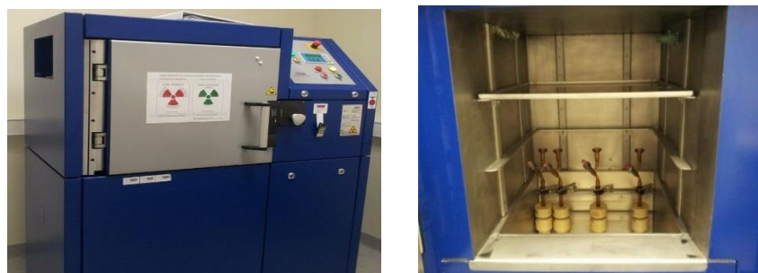
Figure 18: photo de l'irradiateur gamma GSR D1 situé sur le site d'ARRONAX à Saint-Herblain dont la source est du ^{137}\text{Cs} avec une énergie : 0,66 MeV, un débit de dose moyen (bas irradiateur) : 8,0 \pm 0,6 \text{ Gy}\cdot\text{min}^{-1} , T.E.L. : 0,20 \text{ keV}\cdot\mu\text{m}^{-1} .
