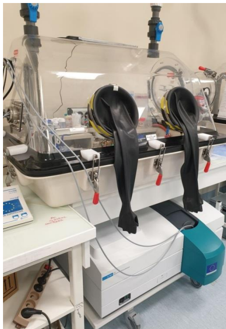
Figure 29 : spectrophotomètre UV-Vis-NIR cary 6000 utilisé pour les analyses en solution et connecté par fibre optique à la Boîte à Gant.
