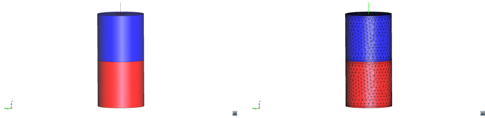
FIGURE 4.13 – Cylindre portant une antenne monopole
