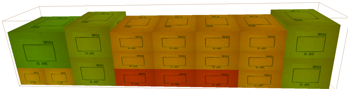
FIGURE 9.7: Une solution de Container Loading ; 19 objets polymorphes, 5 références. Plus un objet est lourd et peut supporter de poids, plus il est rouge foncé. Inversement, moins un objet est lourd et peut supporter de poids, plus il est vert clair.
