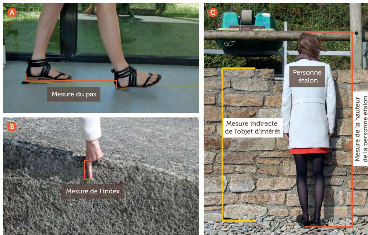
Figure 3.41 : Outils de mesure présents sur soi qui sont intégrés dans CoastAppli (A : le pas ; B : l'index ; C : la personne étalon) (d'après Derval, 2021)
