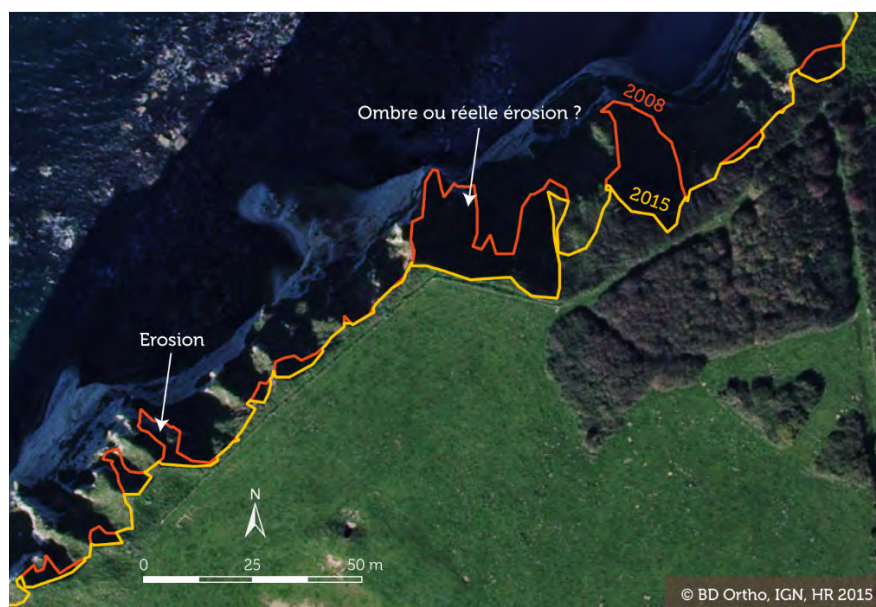
Figure 3.1 : Phénomènes d'érosion et d'ombre, ce dernier nuisant à la photo-interprétation du trait de côte « haut de falaise abrupt crayeux » entre le cap d'Antifer et Etretat
