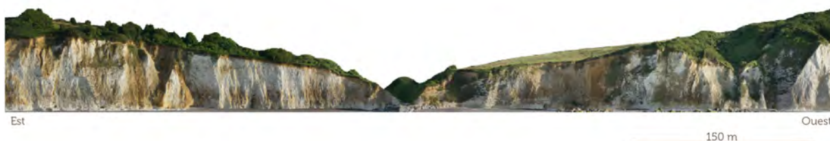
B Reconstruction insatisfaisante (10/06/2017 et 15/06/2017 à 40°, MicMac, UrbanMNE, taille de la fenêtre de corrélation = 5 x 5, valeur de régularisation = 0,20)
