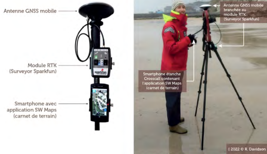
Figure 4.4 : Instruments de la partie « mobile » nécessaires à la photogrammétrie terrestre RTK (modifié du tutoriel de M. Jaud) et l'exemple de son déploiement à Penly pour le suivi de l'érosion des falaises
