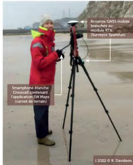
Figure 4.4 : Instruments de la partie « mobile » nécessaires à la photogrammétrie terrestre RTK (modifié du tutoriel de M. Jaud) et l'exemple de son déploiement à Penly pour le suivi de l'érosion des falaises
