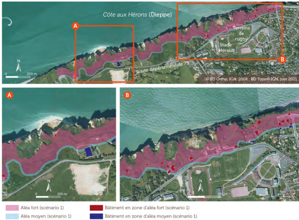
Figure 3.10 : Cartographie de l'aléa « recul des falaises » à la Côte aux Hérons avec le scénario 1 (sans la prise en compte du changement climatique) à l'échéance de 100 ans (en 2108)
