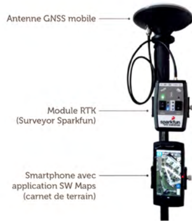
Figure 4.4 : Instruments de la partie « mobile » nécessaires à la photogrammétrie terrestre RTK (modifié du tutoriel de M. Jaud) et l'exemple de son déploiement à Penly pour le suivi de l'érosion des falaises
