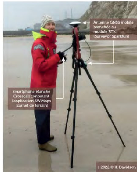
Figure 4.4 : Instruments de la partie « mobile » nécessaires à la photogrammétrie terrestre RTK (modifié du tutoriel de M. Jaud) et l'exemple de son déploiement à Penly pour le suivi de l'érosion des falaises
