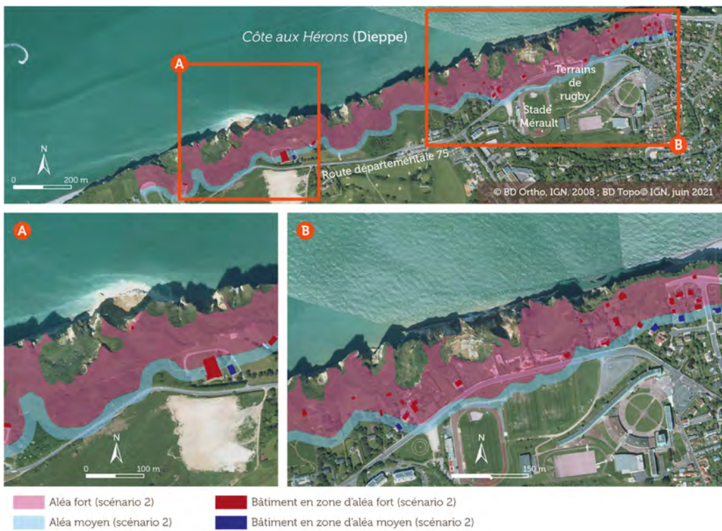
Figure 3.11 : Cartographie de l'aléa « recul des falaises » à la Côte aux Hérons avec le scénario 2 (avec la prise en compte du changement climatique) à l'échéance de 100 ans (en 2108)
