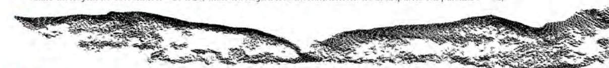
D Reconstruction satisfaisante (10/06/2017 et 15/06/2017 à 40°, MicMac, GeomImage, corrélation multiéchelle = 1, taille de la fenêtre de corrélation = 3 x 3, valeur de régularisation = 0,05)
