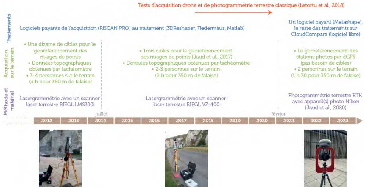
Figure 2.12 : Evolutions dans l'acquisition et le traitement des données sur les sites de Varengville-sur-Mer et de Dieppe
