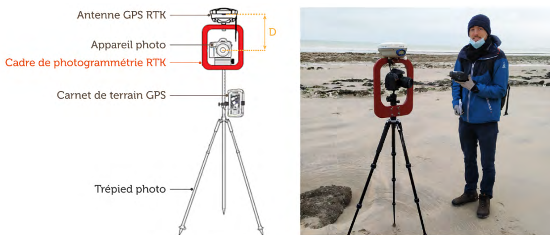
Figure 2.11 : Protocole d'acquisition par photogrammétrie terrestre RTK (Jaud et al., 2020) et sa mise en place à Varengeville-sur-Mer (02/02/2021 avec B. Peuziat)
