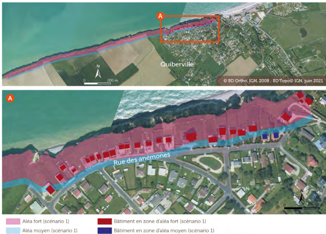
Figure 3.8 : Cartographie de l'aléa « recul des falaises » à Quiberville avec le scénario 1 (sans la prise en compte du changement climatique) à l'échéance de 100 ans (en 2108)
