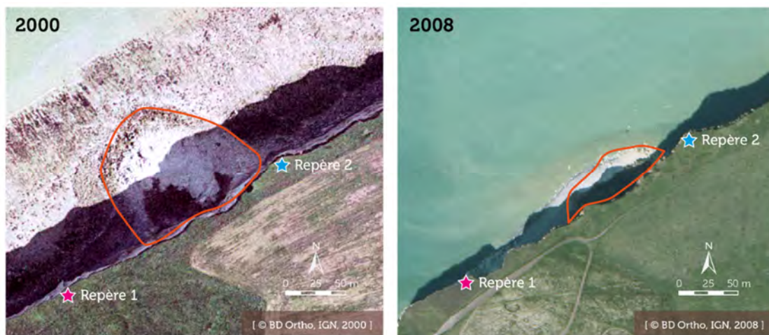
Figure 2.7 : Eboulements/écroulements successifs de pan entier de falaise à Bracquemont (Letortu, 2013)
