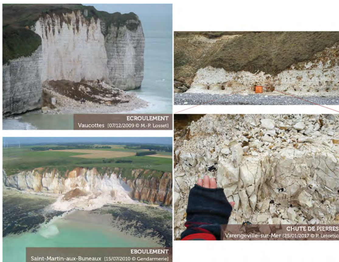
Figure 1.9 : Types de mouvements gravitaires observés en Seine-Maritime (modifié d'après Letortu, 2013)
