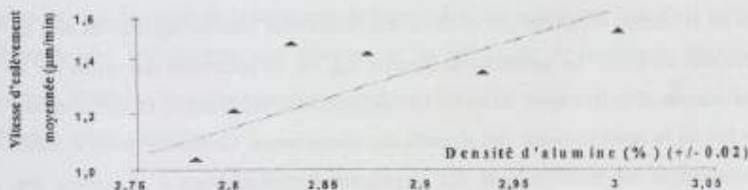
Figure 4-18 Vitesse d'enlèvement moyennée (au bout de 100h de polissage) en fonction de la densité des particules abrasives dans le iCue5003.
