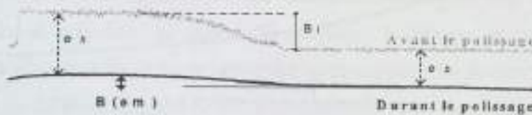
Figure 1-11. Définitions des paramètres de la modélisation de la variation du "bump".
