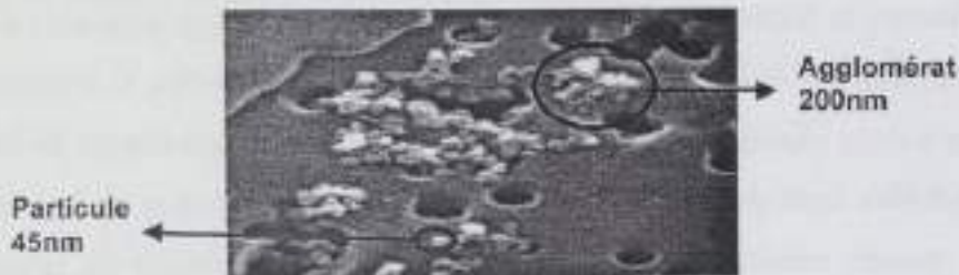
Figure 4-16 Particules d'alumine et agglomérat contenues dans l'abrasif-MEB
