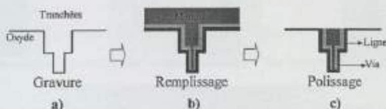
Figure 2-2 Schéma de principe de la fabrication « double damascène ». a)-Les tranchées de la ligne et du via sont fabriquées par gravure, b)-elles sont remplies avec des dépôts successifs de métaux, c)-l'excès de matière est retiré par polissage.
