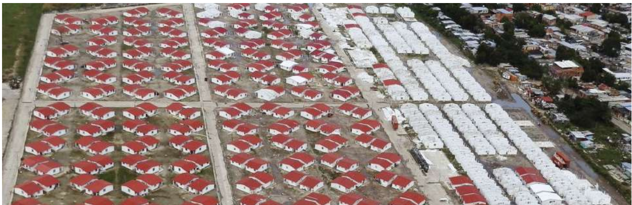
Image 86. Pétrocasas en production. Au Venezuela, vers l'année 2007, la production de logements appelés « Pétrocasas », de Petro : pétrole et casa : maison, parfois appelés aussi « oil house » en anglais, était en plein essor. Leur particularité consistait en l'utilisation du polychlorure de vinyle (PVC) comme matériau de base de leur fabrication.
