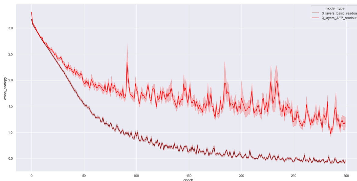
FIGURE 4.15 : Courbes d'apprentissage moyennes pour 3 couches de convolution, avec différentes fonctions de readout.
