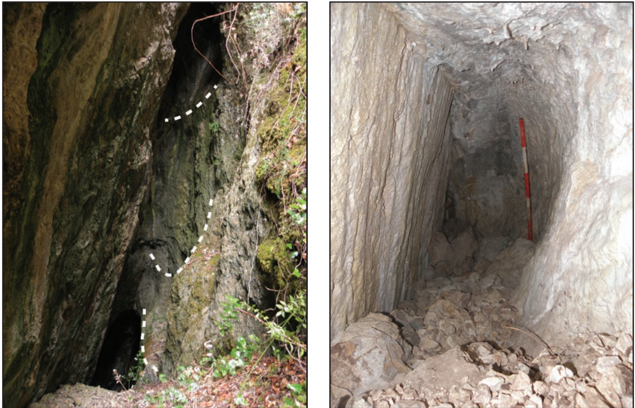
Fig. 136 : mine de Tistoulet, tranchée Tistoulet 1, niveaux de progression des mineurs (à g.), et galerie creusée à la pointerolle le long d'un miroir de faille (à dr.)
