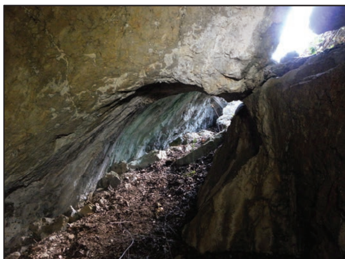
Fig. 149 : Esquina d'Ase 21-22, chantier creusé par le feu sur un filon subvertical et pilier de soutènement laissé par les mineurs (à dr.).
