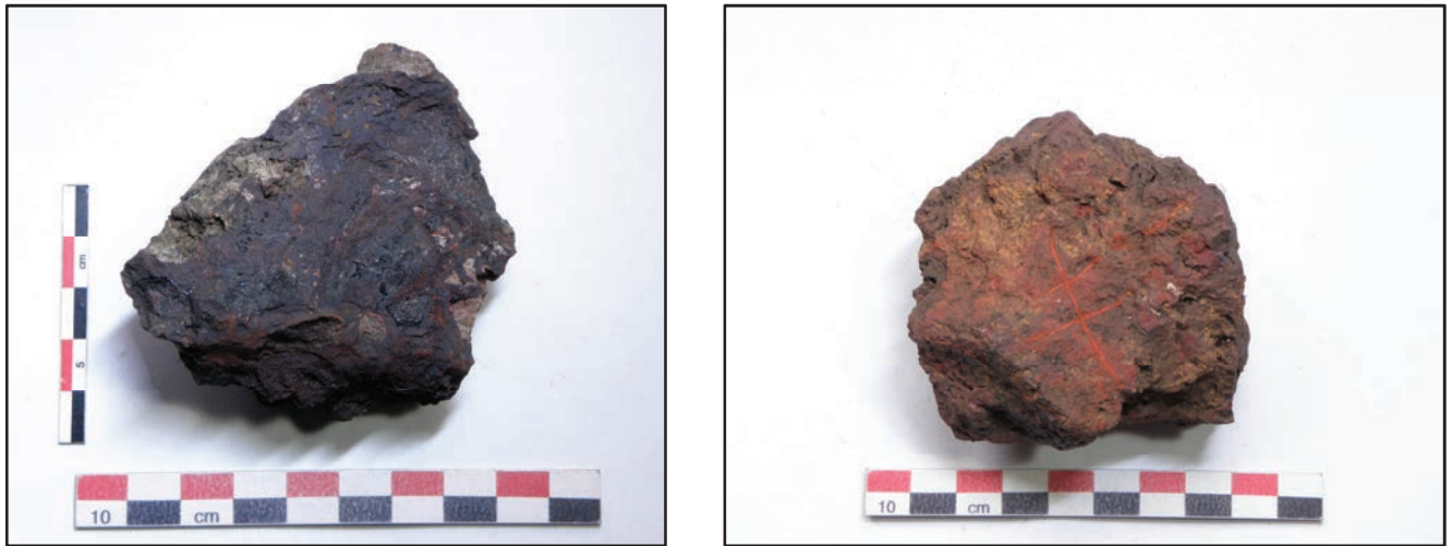
Fig. 266 : minerai de fer (hématite, goéthite) (provenance : ferriers de Caraillet-Adoux (à g.) et Fourques 1 (à dr.). Le second a visiblement subi un impact thermique.
