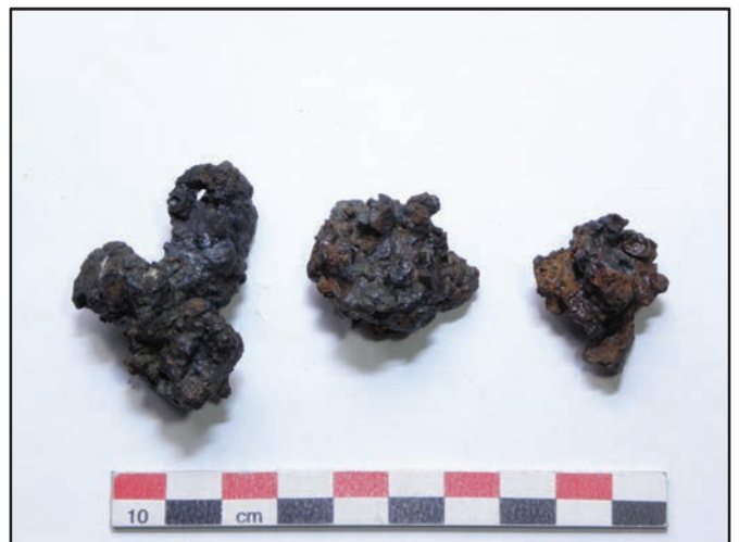
Fig. 273 : scories oxydées magnétiques (à g.) et résidus de fer informés (à dr. et à g. ?) (provenance : ferriers de Lizadou 1 à g., de Caraillet 1 de Palairac à dr.)
