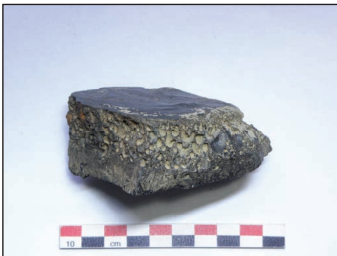
Fig. 269 : scories écoulées en plaque (provenance : épandage de scories de La Peyre-Les Vignes Grandes).
