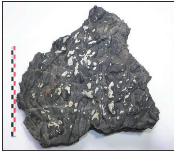
Fig. 268 : scorie écoulée à cordons juxtaposés (provenance : ferrier du Caraillet-Adoux 1).
