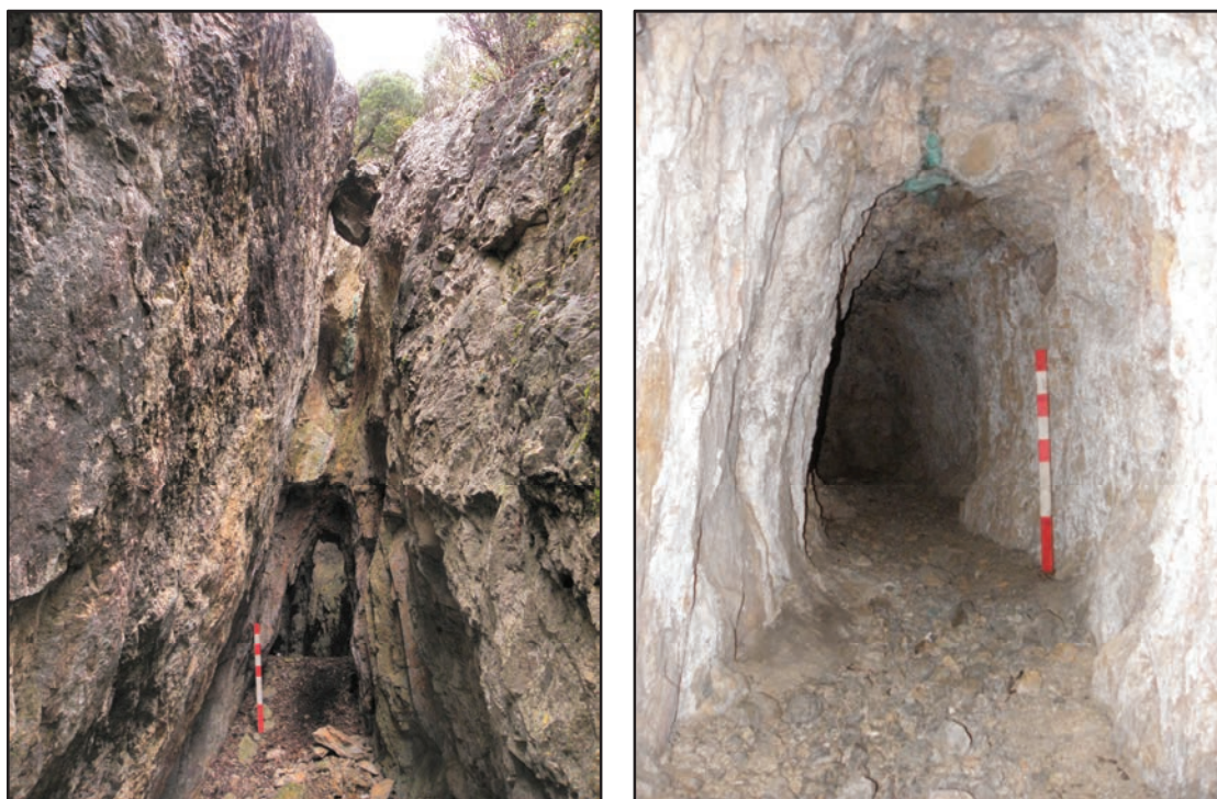
Fig. 138 : mine de Tistoulet, chantier à ciel ouvert Aigas Caudas 2 (à g.) et galerie de recherche creusée au XIX ème s. dans le prolongement du chantier (à dr.).
