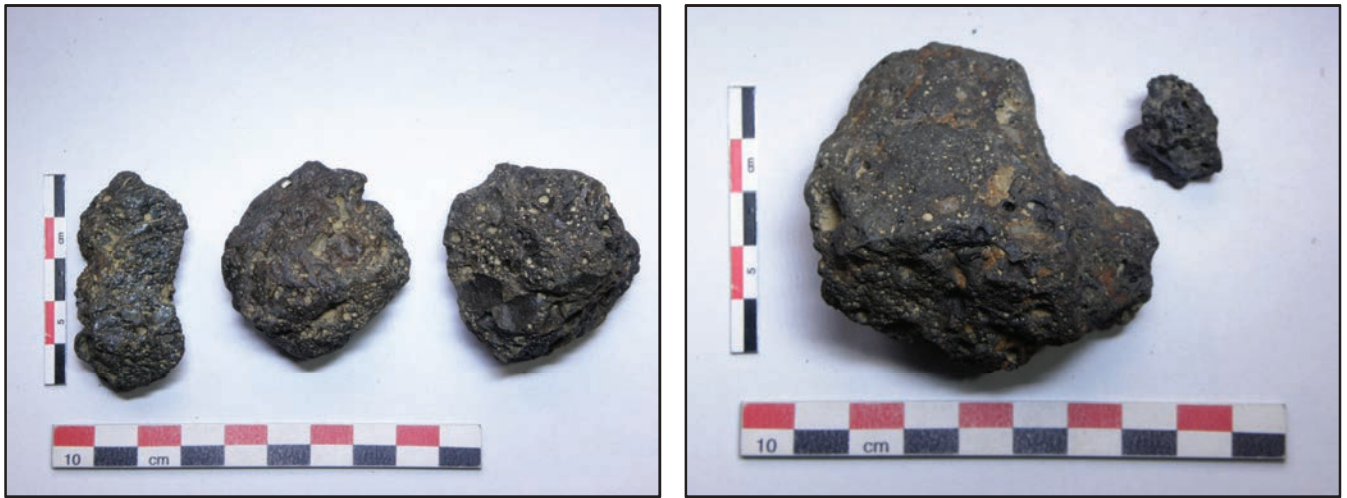
Fig. 270 : scories grises denses cristallisées informelles (provenance : épandage de scories d'Espeyrols 2).
