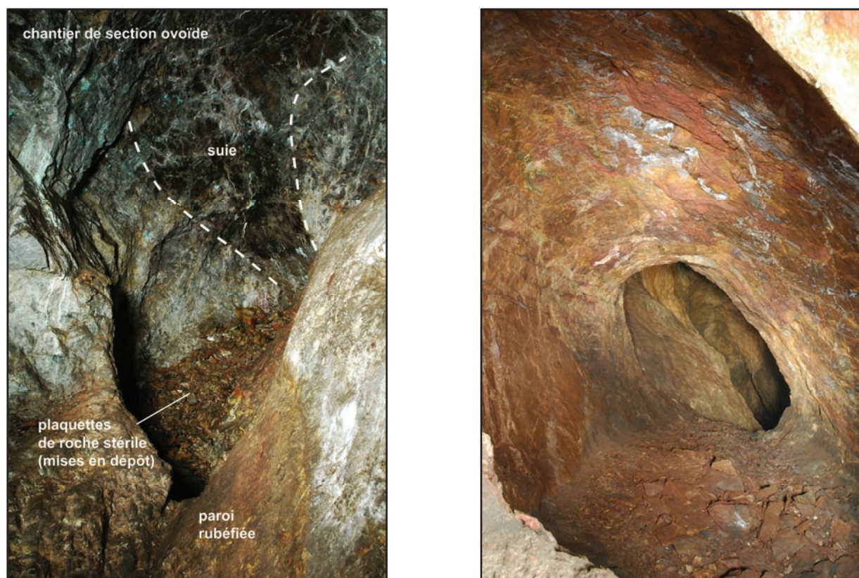
Fig. 95 : Mourral de la Grave, traces caractéristiques laissées par la pratique de l'abattage par le feu (à g. : chantier S178-S182) (cl. J. Maintenant et J.-M. Fabre).
