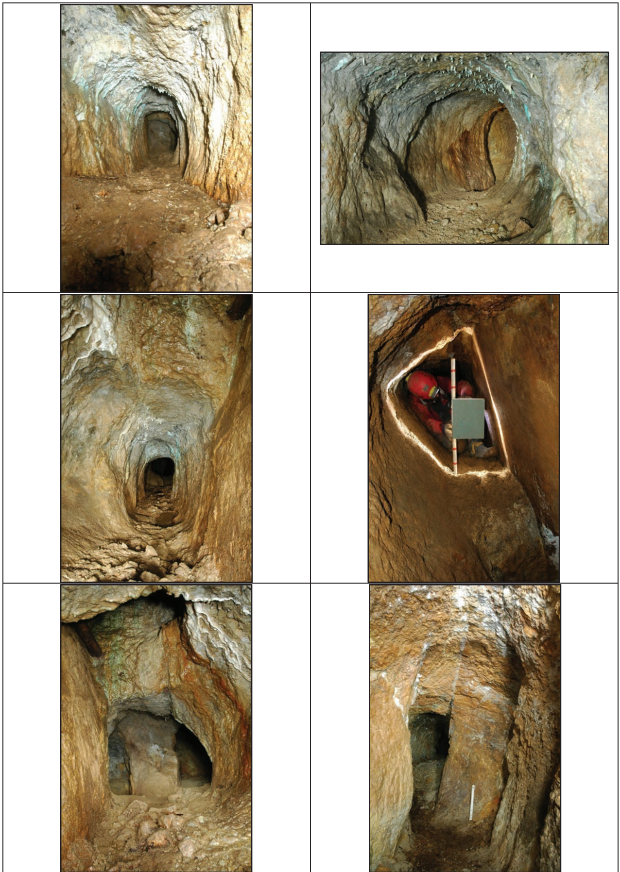
Fig. 85 : Mourral de La Grave : galeries de recherche (haut), galeries de recherche creusées le long d'un miroir de faille (milieu) et galeries de recherche creusées de part et d'autre du filon (bas) (cl. J.-M. Fabre, E. Kammenthaler).
