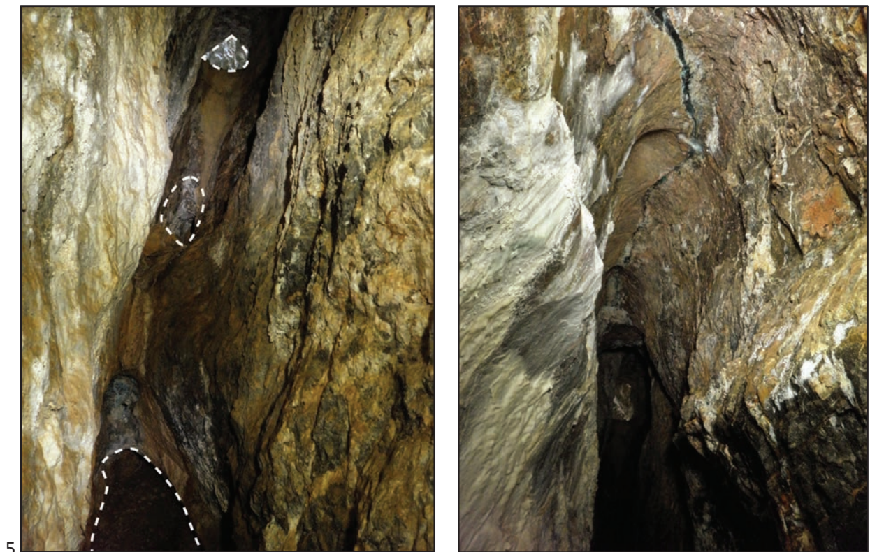
Fig. 137 : mine de Tistoulet, chantier vertical Tistoulet 14, reliquats de galeries étagées (à g.), filon suivi par les mineurs (sur voûte) et reliquat de la galerie du niveau supérieur (à dr.).
