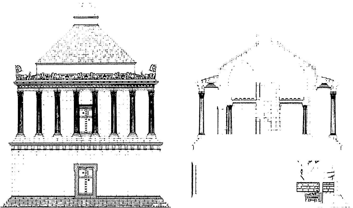
1. Mausolée de Belevi, restitutions de l'élévation nord et de la coupe transversale, d'après Praschniker, 1948, pl 1 et Praschniker et Theuer, 1979, pl 10
