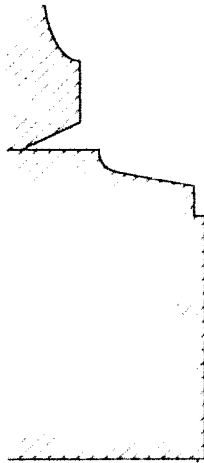
Moulure à la base du mur externe
