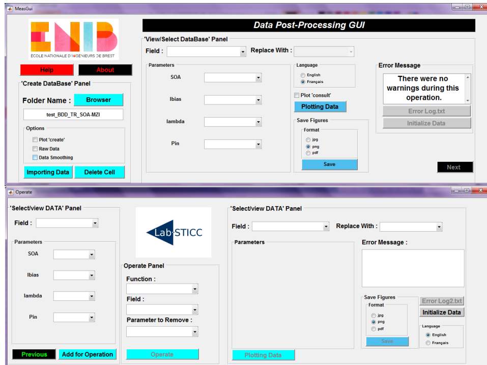
FIGURE 1.1 – Interface graphique développée par Y. Ait Hammou lors de son stage à l'ENIB [93]. La partie supérieure présente l'interface principale. La partie inférieure présente l'onglet « Operate » qui permet de modifier la base de données.
