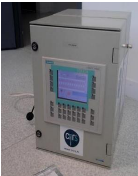
Figure 2-13 Echantillonneur de cartouches DNPH, fabriqué à l'ICARE-CNRS Orléans.
